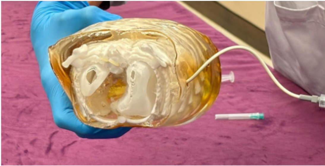
團隊參照雞皮和內臟等軟硬度製作兒童人體模型 蘇楚淅攝 來源：商台新聞
